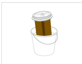
Оставляем мембрану в растворе лимонной кислоты на несколько часов
